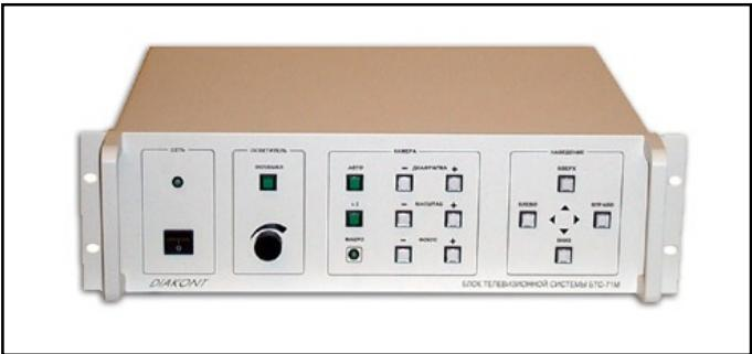
CCU の電子回路にはオートアイリス機能があります。オートアイリス機能は観察部位の明るさが変わっても最良の映像になるようにコントロールします。アイリスのマニュアル操作、オートアイリスの ON/OFF がフロントパネルから遠隔操作できます。
